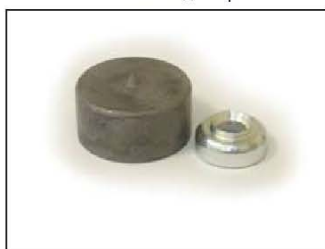
Фото №9 Оправка для разметки
