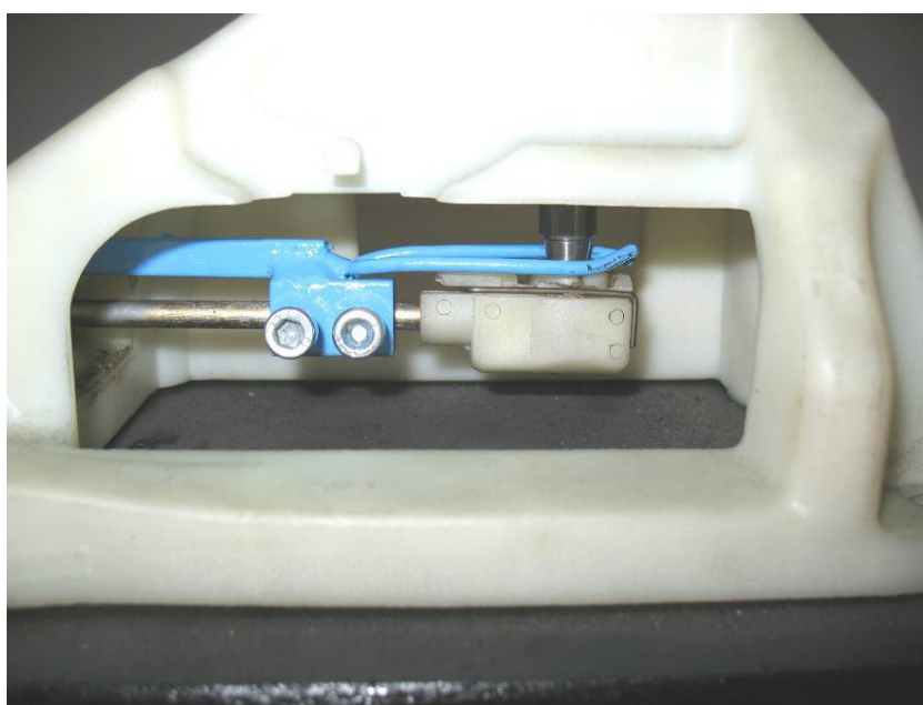
Рисунок 12. Подгибание усиков блокирующего элемента
