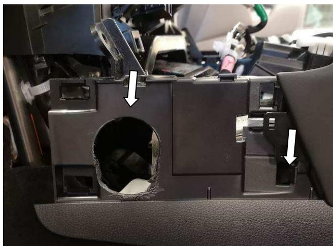
В внутренней накладке левой стенки центральной консоли необходимо просверлить отверстие  $\Phi 35$ - $\Phi 40$  мм, для беспрепятственной установки блокиратора КПП.
