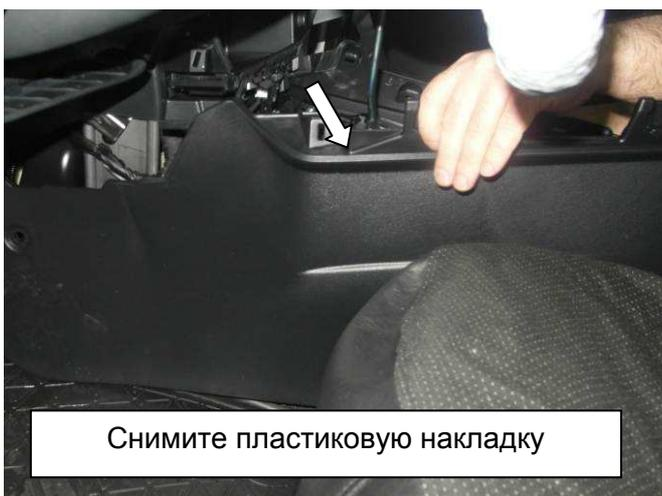
Снимите пластиковую накладку
