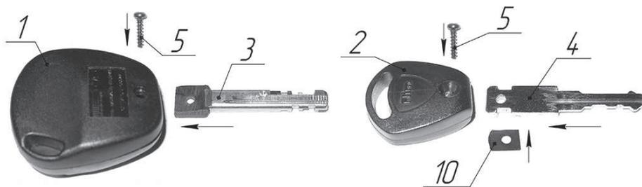
**Схема №2. Uaz Patriot, Chevrolet Niva (без брелока АПС-6).** Вынуть из штатного ключа **6** ложемент **7** с чипом иммобилизатора **8**. Ложемент **7** вставить назад в штатный ключ **6**, а чип иммобилизатора **8** вставить в державку ключа «ФЛИМ» **2**. Затем в державку ключа «ФЛИМ» **2** вставить стержень от замка «ГАРАНТ БАСТИОН» **3** с гайкой **10** и закрепить его винтом **5**.
